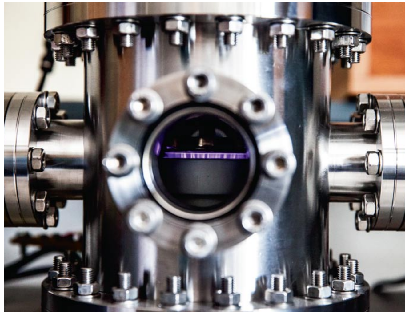
Ο ΚΑΘΑΡΙΣΜΟΣ ΤΟΥ ΧΩΜΑΤΟΣ γίνεται με ψυχρό πλάσμα, δηλαδή τα ελεύθερα ηλεκτρόνια και τα υπόλοιπα σωματίδια από τα οποία αποτελείται κάθε ηλεκτρική εκκένωση.
